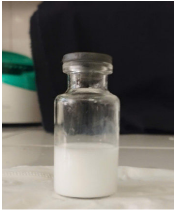
Hình 2a. Dung dịch polystyrene thu được sau quá trình trùng hợp
