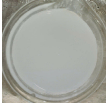
Hình 2b. Màng polystyrene cấu trúc opal (OPC-PS) được trải trên nền kính
