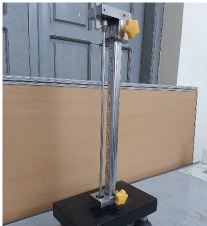
Hình 3. Dụng cụ và phép đo độ đàn hồi nảy kiểu thả rơi
