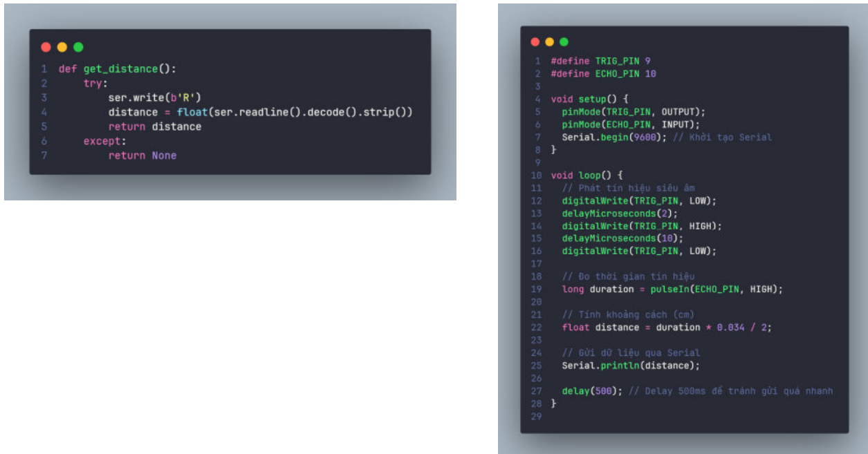
Hình 6. Chương trình từ Arduino thực hiện việc lấy dữ liệu khoảng cách từ cảm biến siêu âm
