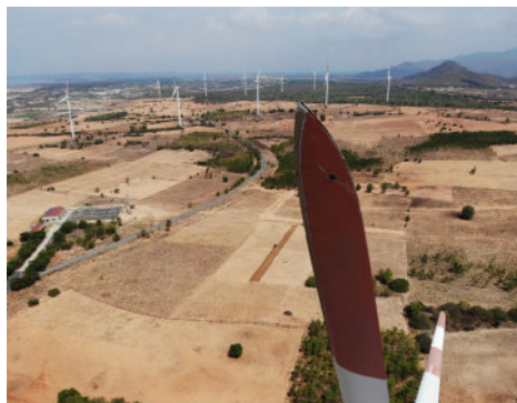
Hình 2. Sét đánh làm hư hỏng cánh WT tại WF Tuy Phong 1
