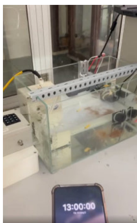
Hình 6. Máy bơm sục cung cấp ôxi cho nguồn nước nuôi thủy sản tự động bơm theo giờ cài đặt
