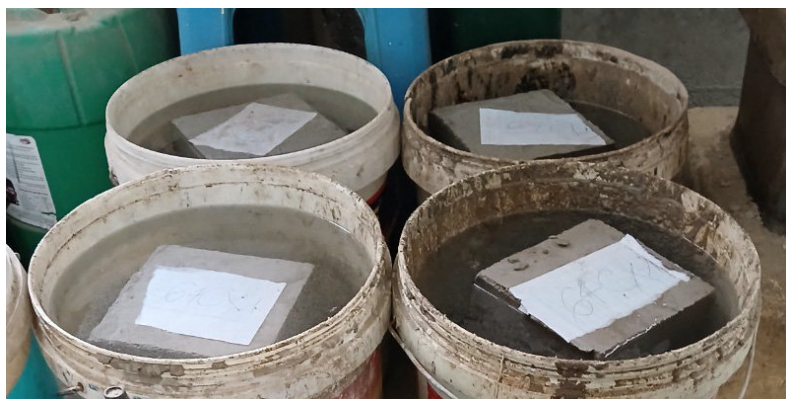
Hình 7. Bảo dưỡng bê tông
