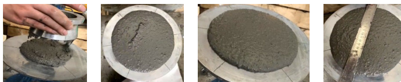
Hình 2. Xác định độ xòe của hỗn hợp bê tông xanh trong côn tiêu chuẩn
