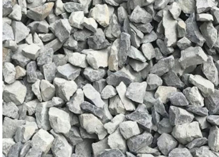
Hình 2. Đá dăm đường kính lớn nhất 40mm
