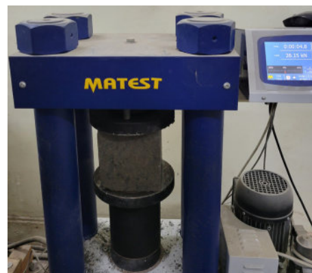
Hình 8. Thí nghiệm nén mẫu bê tông
