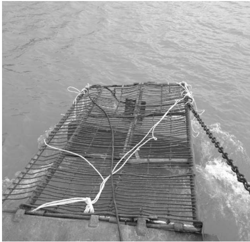
Hình 1. Ăng ten nước tần số 80MHz
